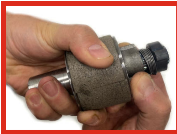
Napinanie wstępne ruchomego stożka. Następuje naciągnięcie sprężyny.
