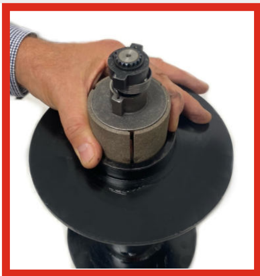
Wsuwanie naprężonego hamulca do bębna wyciągarki
