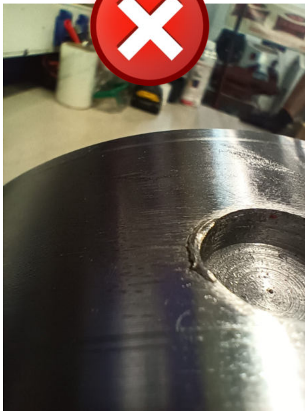
uszkodzone gniazda w pierścieniu zębatym
