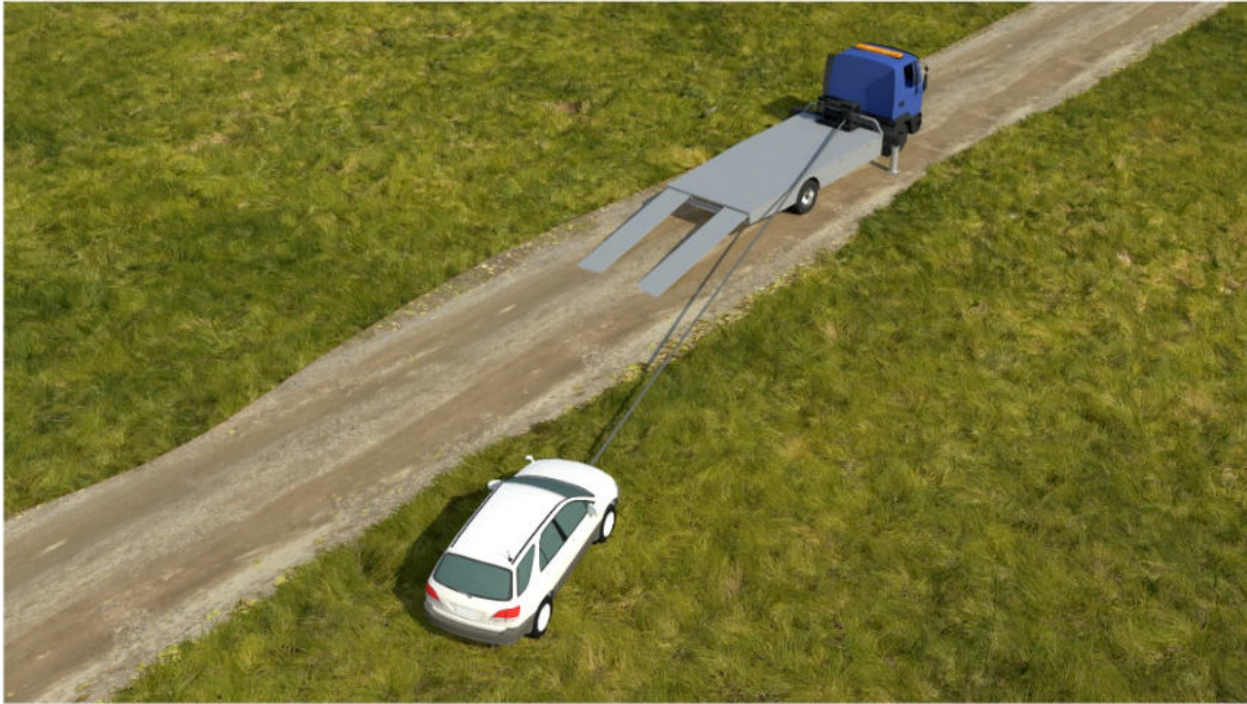
Maksymalnie dopuszczalny kąt, pod jakim może być wciągany element.
