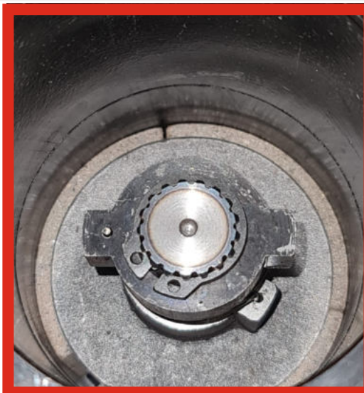
Po włożeniu hamulca do bębna następuje nieznaczne rozprężenie sprężyny, efektem tego skrzydełka znajdują się pod niewielkim kątem.
