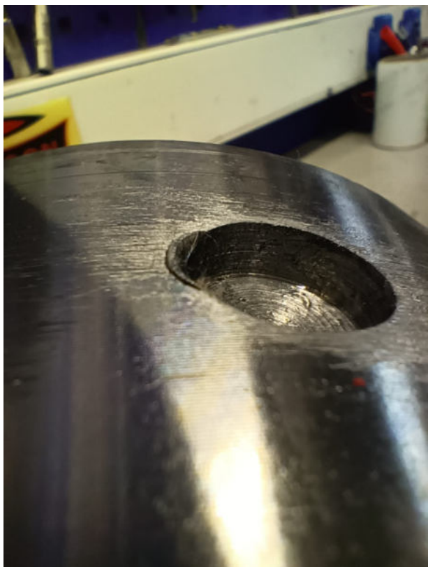
uszkodzone gniazda w pierścieniu zębatym
