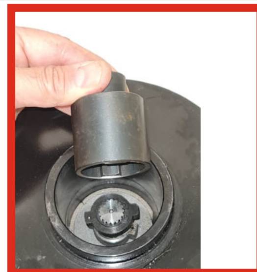
Na tak włożony hamulec nakładamy zabierak, którego wypusty muszą się znaleźć pomiędzy skrzydełkami które są po przeciwnych stronach.
